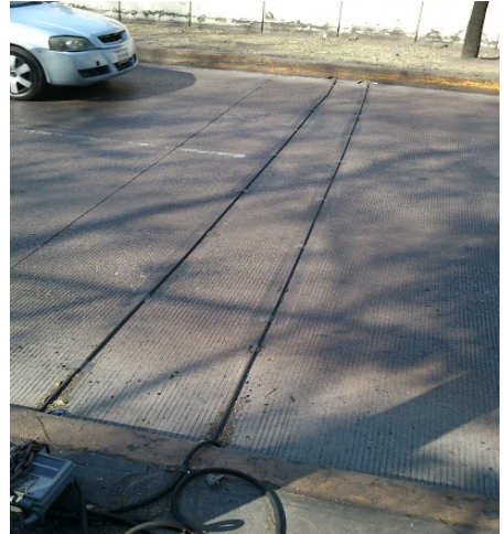
Fig. 1. Contador neumático sobre Circuito Interior, Ciudad de México
